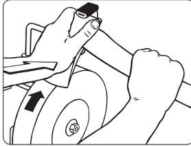
Premere con il palmo della mano sulla scure in prossimità della pietra. La scure sarà automaticamente spinta contro il fermo del dispositivo e l'affilatura risulterà più efficiente.
