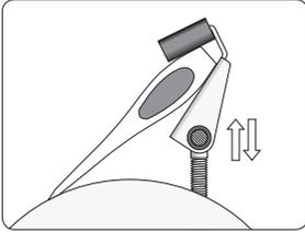
Collocare la scure nel dispositivo. Impostare l'angolo di taglio regolando l'altezza del supporto universale. Se occorre riprodurre l'angolo originale, utilizzare il metodo del pennarello, se invece si desidera impostare un nuovo angolo, servirsi del posizionatore d'angoli.
